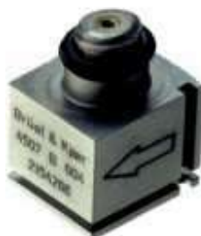
Рисунок 1.9. Акселерометр CCLD 4507 (Brüel & Kjær), що встановлюється на осі колеса: діапазон вимірювання: 0-700 м.с -2 , діапазон частоти 0.3 Гц - 6 кГц
