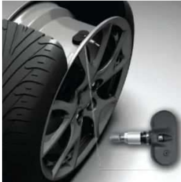
Рисунок 5.2 - Монтаж датчиків тиску
