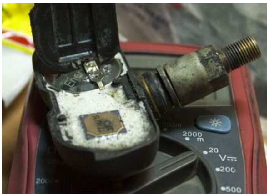
Рисунок 5.12 – Демонтаж датчика тиску в шинах
