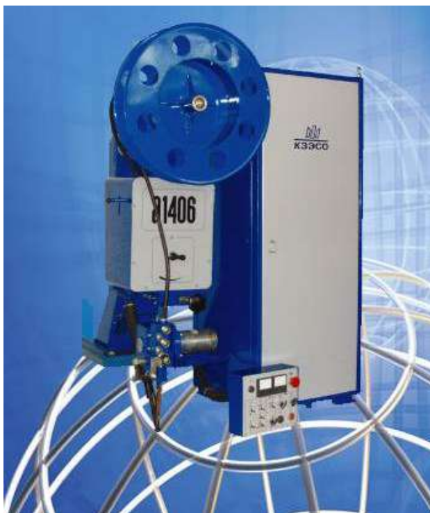
Рис. 2.11. Зовнішній вигляд наплавлювального або зварювального апарату В-1406
