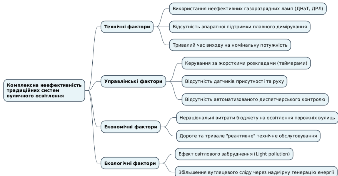
Рисунок 1.4 – Діаграма причинно-наслідкових зв'язків неефективності традиційних систем вуличного освітлення
