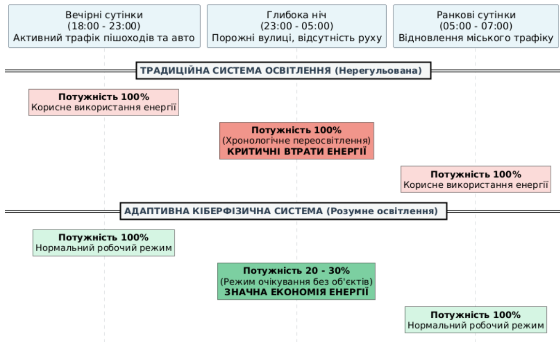
Рисунок 1.2 - Профіль споживання електроенергії нерегульованою системою освітлення протягом доби
