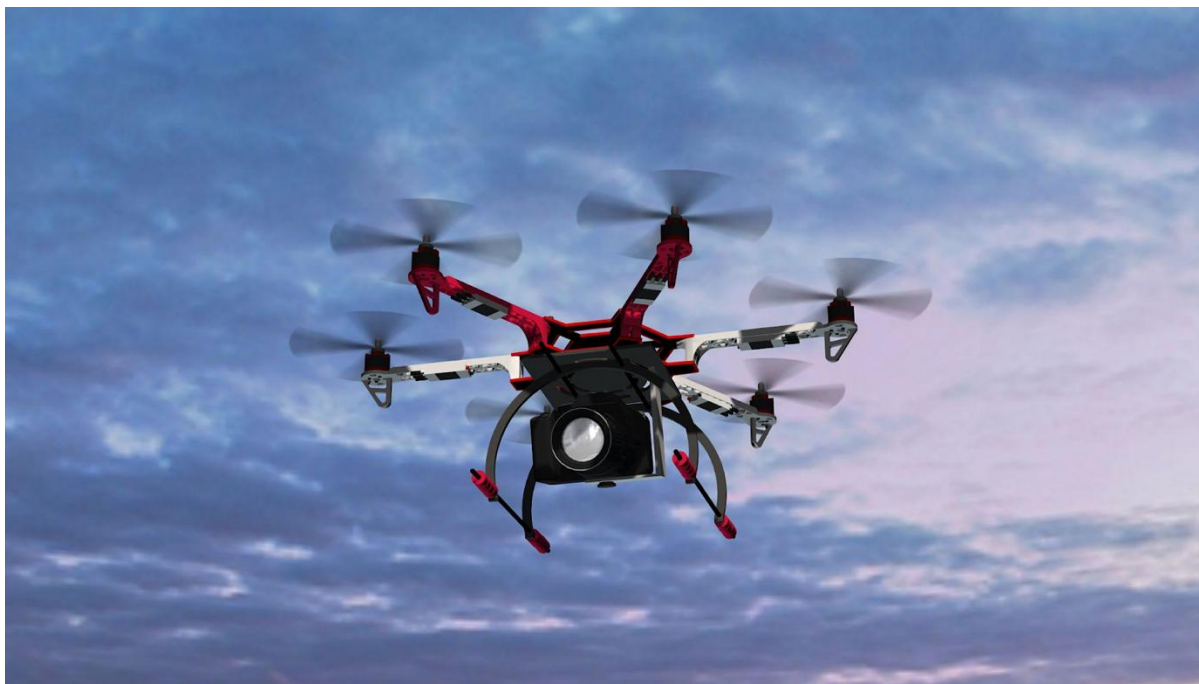
Рисунок 1.1 – Приклад зображення мультикоптера [1]: (а) квадрокоптер, б) гексакоптер підвищеної вантажопідйомності)
