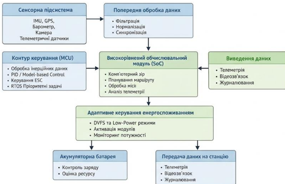
Рисунок 2.2 – Структурна схема енергоефективної бортової комп’ютерної системи малого БПЛА
