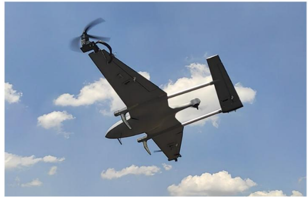
Рисунок 1.3 – Гібридний малий БПЛА типу VTOL [3]
