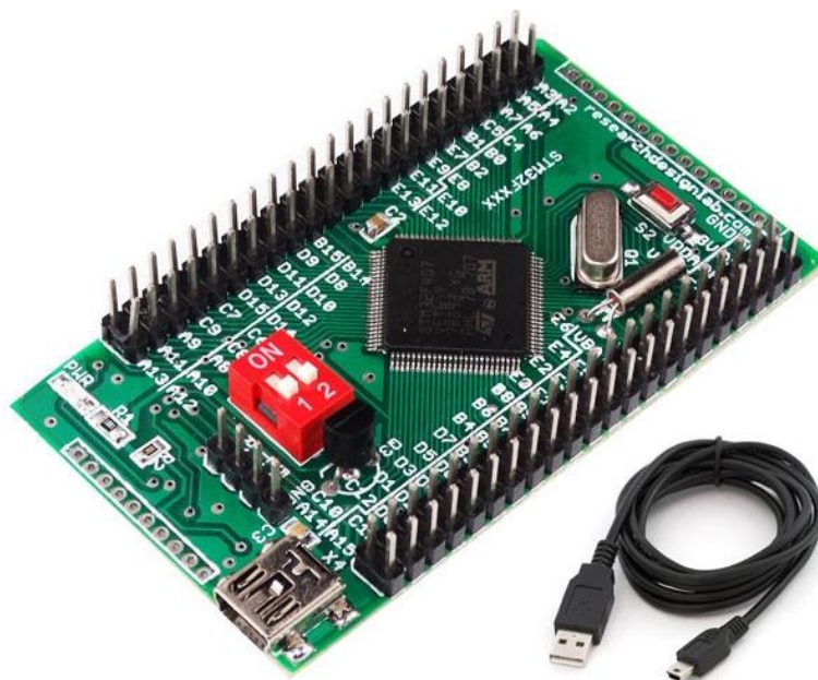
Рисунок 2.3 – Мікроконтролер для реалізації контуру керування реального часу БПЛА [33]
