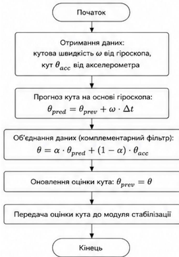
Рисунок 3.3 – Алгоритм комплементарного фільтру
