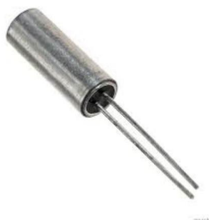
Рисунок 2.14 – Кварцовий резонатор кварц 32.768 кГц
