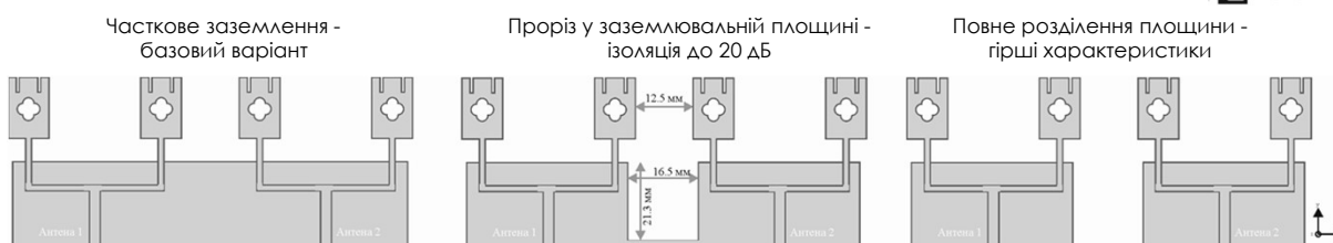
Рис. 4. Модифікації заземлювальної площини двоелементної МІМО-антени
