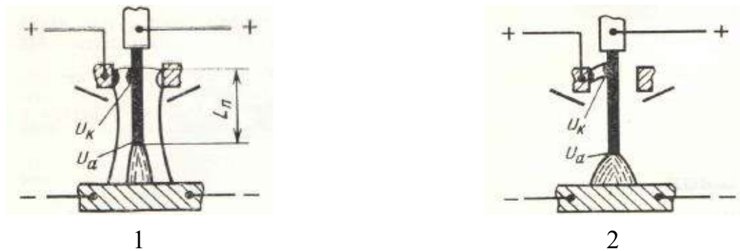
Рисунок 1.6. Схема плазма-МІГ: 1 – стабільний процес, 2 – порушення процесу (виникнення другої дуги). E_{ст} – градієнт потенціалу стовпа плазмової дуги; L_n – ділянка вильоту електрода, що у контакті з плазмою; U_k - катодне падіння напруги від струму плазмової дуги; U_a - анодне падіння напруги на торці електрода, що плавиться; U_b – падіння напруги на вильоті, що плавиться електрода [35]
