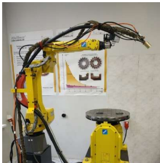
Рисунок 3.7. Компонування обладнання для WAAM на базі роботизованого комплексу
