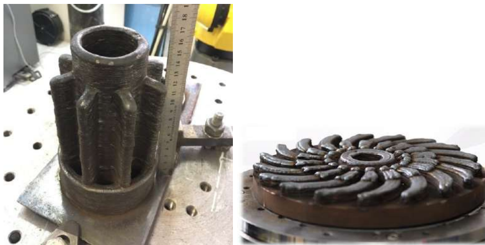
Рисунок 3.8. Заготівлі деталей (сердечник - ліворуч, імпеллер - праворуч), створені на роботизованому комплексі
