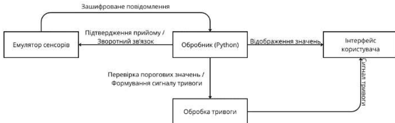
Рисунок 4.2. Послідовність передачі даних та сигналу тривоги у тестовому середовищі
