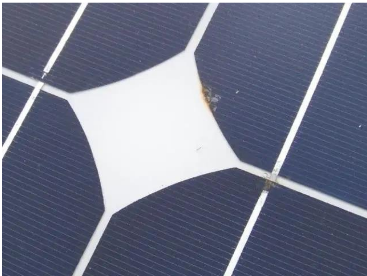
Рисунок 2.3 – Гаряча точка на сонячній панелі
