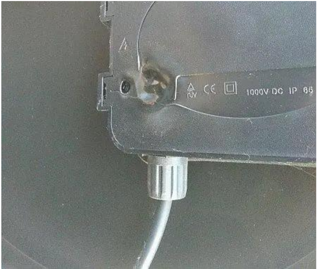
Рисунок 2.10 – Згорівші з'єднання у розподільчій коробці
