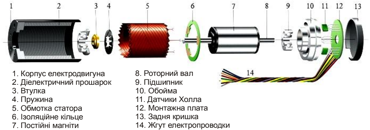
Рисунок 1.7 – Будова вентильного двигуна
