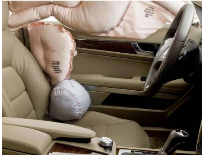
Рисунок 1.12 – Приклад двокамерної бічної подушки безпеки
