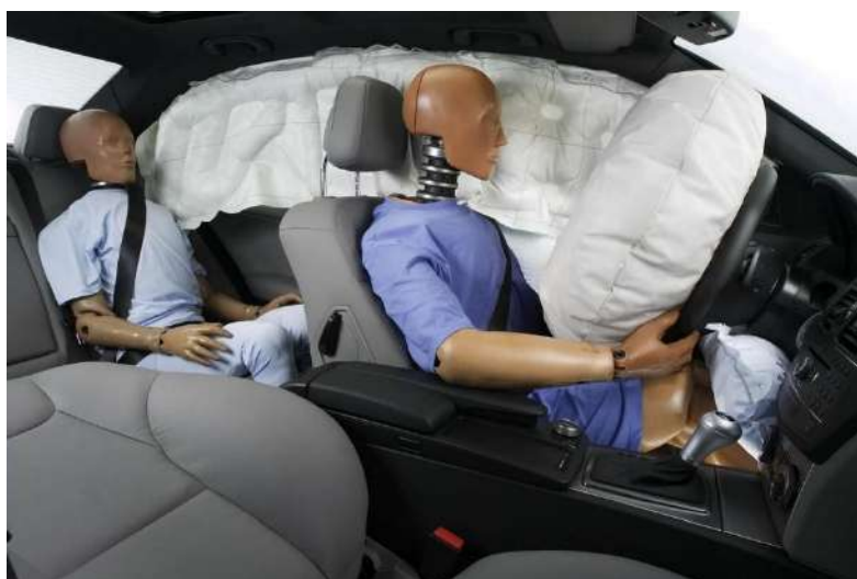
Рисунок 1.5 – Приклад подушок безпеки, що спрацювали.
