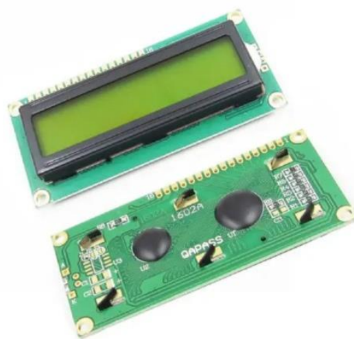
Рисунок 2.4 – LCD 1602 символьний дисплей 16x2 [50]
