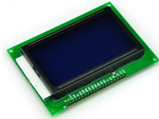
Рисунок 2.5 – LCD 12864 графічний дисплей 128x64 [51]
