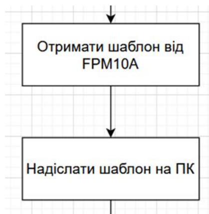
Рисунок 3.7 – Обробка та передача шаблону мікроконтролером
