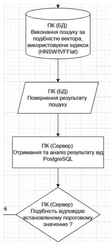
Рисунок 3.18 – Взаємодія з PostgreSQL для пошуку за подібністю та підготовка до прийняття рішення
