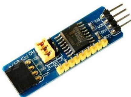
Рисунок 2.5 - Плата розширення PCF8574
