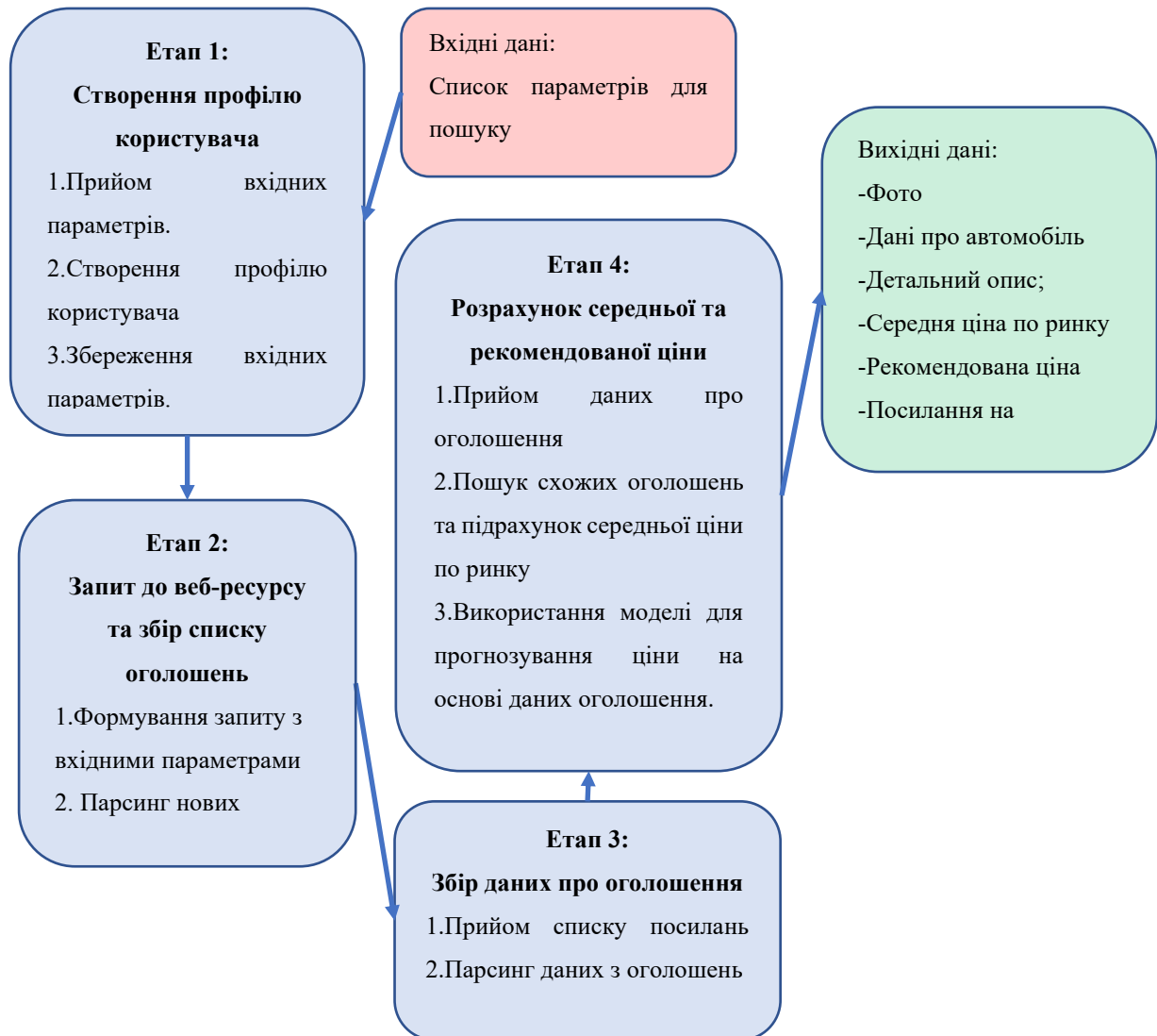
Рисунок 2.1 – Схема роботи способу автоматизованого моніторингу оголошень онлайн-ринку вживаних авто
