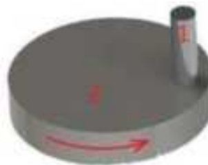
Рисунок 2.1 – Схема випробувань на зношування: штифт-на-диску:
