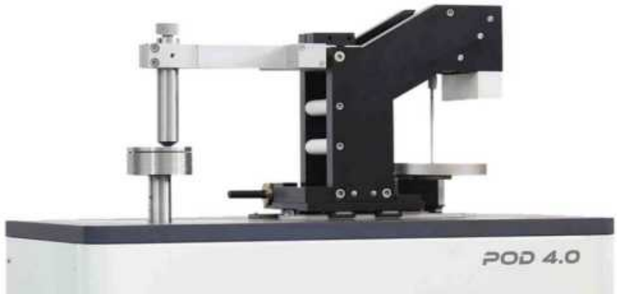
Рисунок 2.2 – Загальний вигляд трибометра DUCOM POD-4.0.
