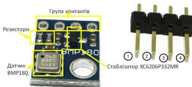
Рисунок 2.6 – Датчик тиску BMP180 і стабілізатор напруги XC6206P332MR
