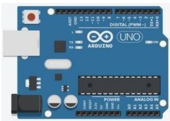
Рисунок 2.2 – Основні порти плати Arduino Uno
