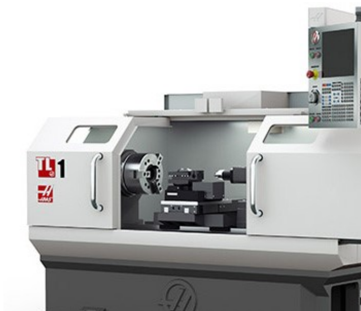
Рисунок 2.10 – Токарний верстат з ЧПК HAAS TL-1
