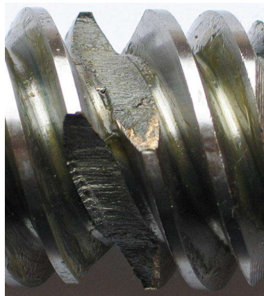
Рисунок 4.2 – Види пошкодження зубів колеса:
