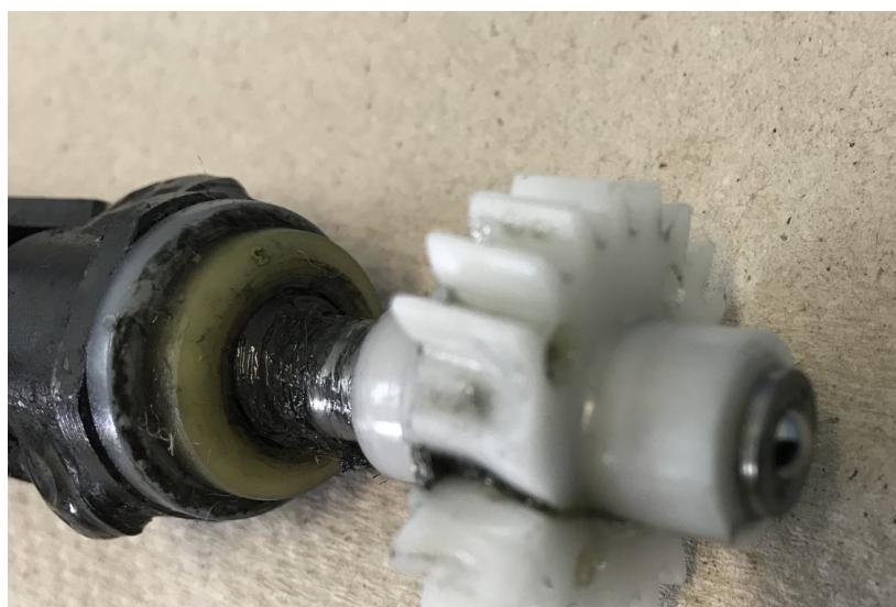
Рисунок 1.3 – Зруйновані зубці червячного колеса
