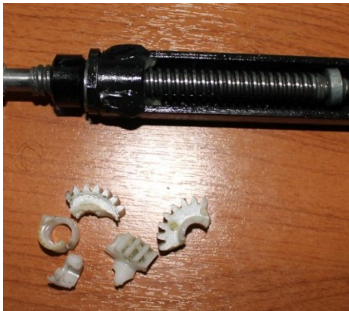
Рисунок 1.4 – Розбите пластикове черв'ячне колесо
