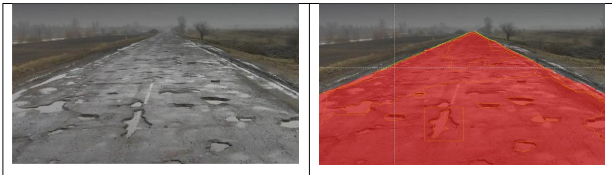
Рисунок 3.4. – Оригінальний кадр дорожньої обстановки (зліва) та згенерована бінарна маска дорожньої розмітки (справа).
