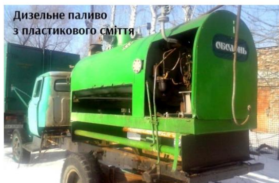
Рис. 1. Мобільна установка переробки пластикових пляшок у дизельне паливо компанії «Оболонь Ойл»
