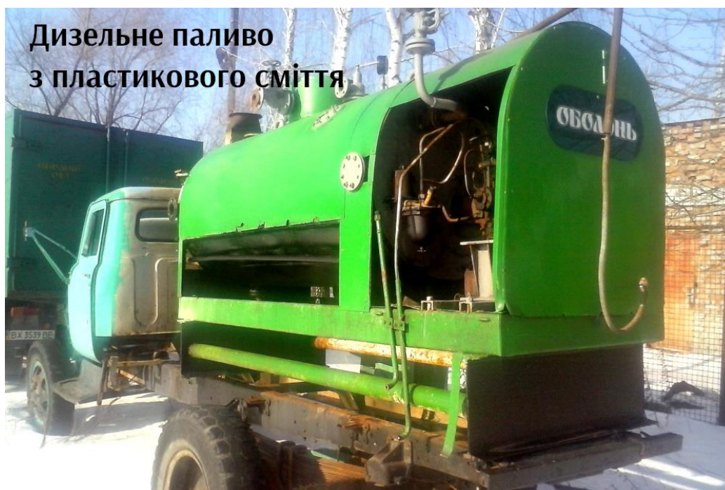
Рисунок 1.1 – Мобільна установка переробки пластикових пляшок у дизельне паливо компанії «Оболонь Оіл»
