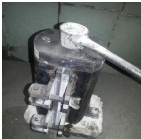
Рисунок 2.3 – Кокиль для виготовлення технологічних проб
