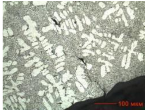
Рисунок 3.12 – Мікроструктура виливки поблизу зони руйнування
