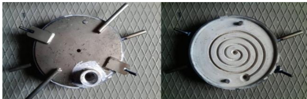
Малюнок 2.6 – Металева форма для отримання проб текучості металів
