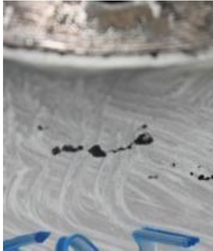
Рисунок 3.11 – Зона зародження тріщини
