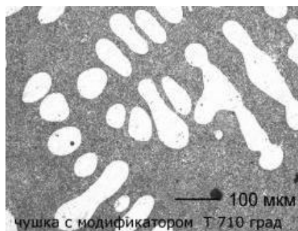
Рисунок 4.5 – Мікроструктура чушки: а – без модифікування; б – модифікатор вводили на роторній установці при температурі лиття 710 °С
