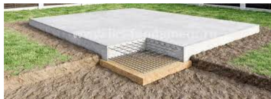
Рис.3.4.3. Плитний фундамент (силова плита)
