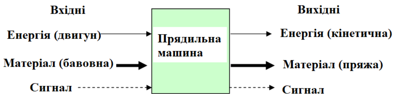
Рисунок 2.8 – Функціональна схема прядильної машини
