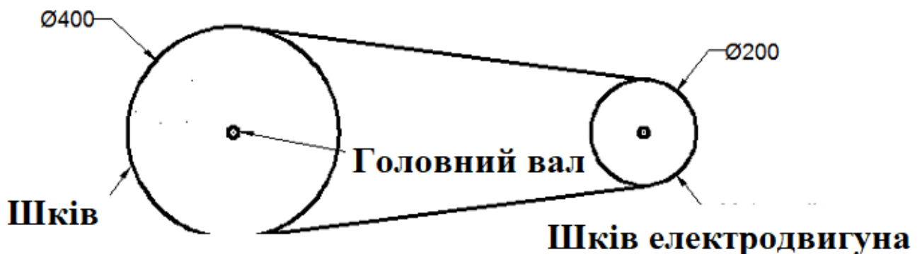
Рисунок 3.20 – Схема розташування головного валу та електродвигуна
