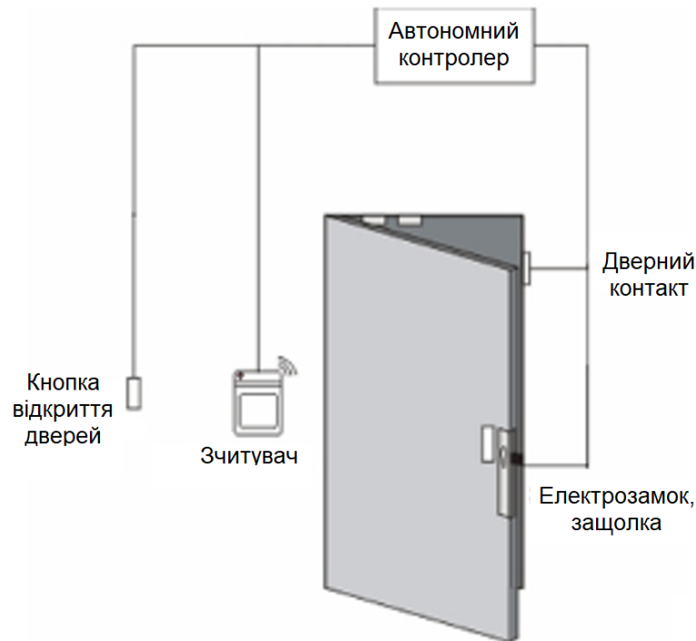
Рисунок 2.1 - Структура автономної СКУД
