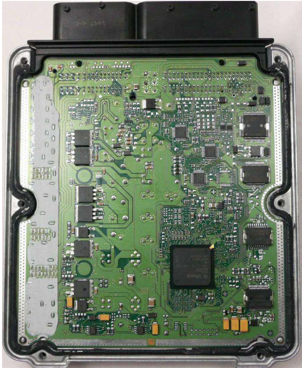
Рисунок 3.1 Електронний блок керування двигуном BOSCH_EDC17CP04
