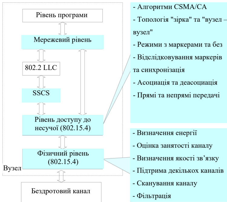
Рис. 2. Структура компонентів моделі LR-WPAN NS-2
