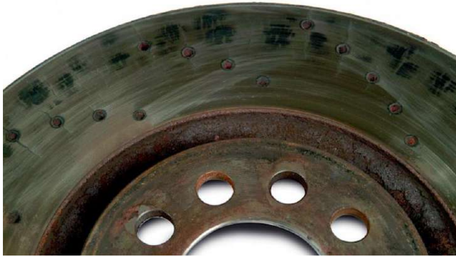
Рис. 2.13 – Синьо–чорні сліди перегріву на поверхні гальмівного диска [14]
