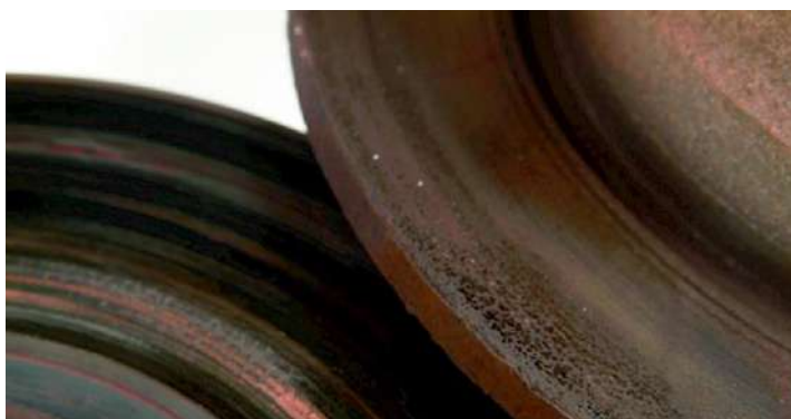
Рис. 2.10 – Частина фрикційного матеріалу спрацювалися / «згоріли» в зоні гальмування [14]
