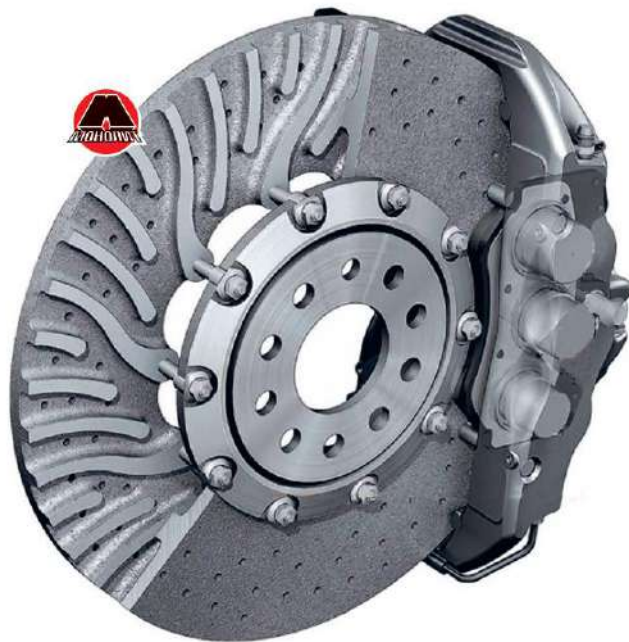
Рис. 2.2 – Приклад вентилязованого гальмівного диска [12]
