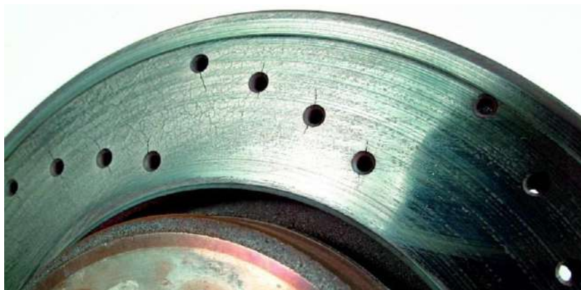
Рис.2.12 – Структурні зміни механічних властивостей виливки та/або фрикційної поверхні [14]
