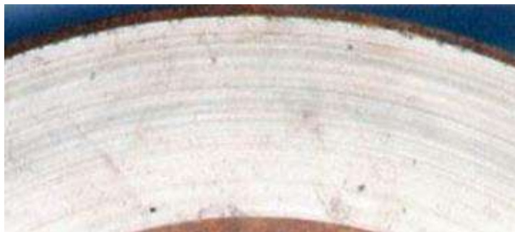
Рис. 2.8 – Вм'ятини, вибоїни на контактній поверхні гальмівного диска [13]
