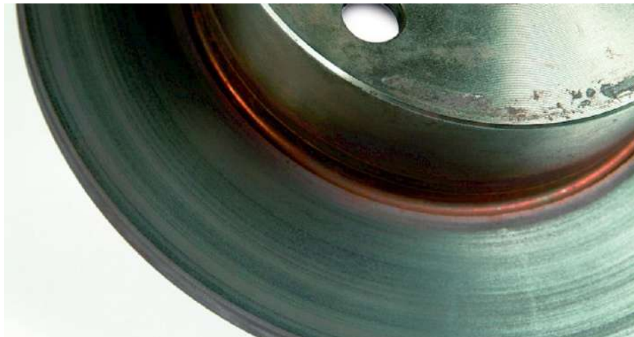
Рис. 2.6 – Кольори відпалу (від білого до сірого) [13]
