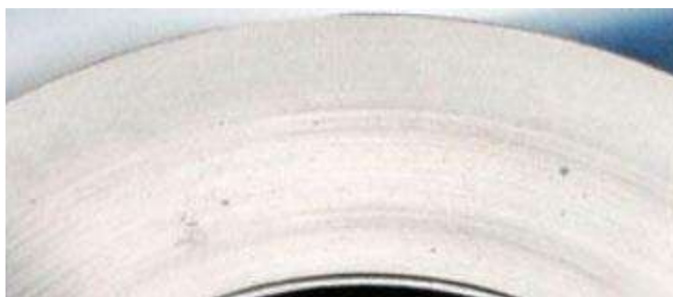
Рис. 2.5 – Нерівномірне зношення гальмівного диска [13]
