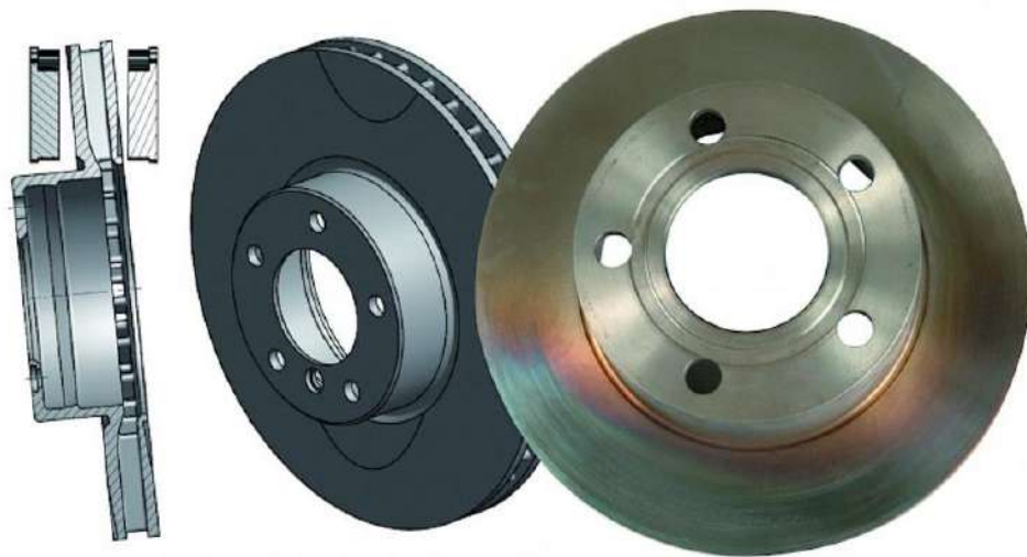
Рис. 2.7 – Синьо–чорні сліди перегріву на поверхні гальмівного диска [14]
