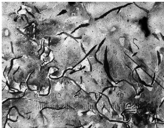
Рис. 4.1 – Мікрофотографія сірого чавуну; структура перемережована чорними пластівцями пластинчастого графіту
