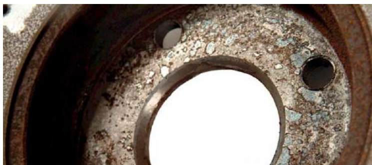
Рис. 2.9 – Сліди тиску та корозія контактної поверхні гальмівного диска [13]
