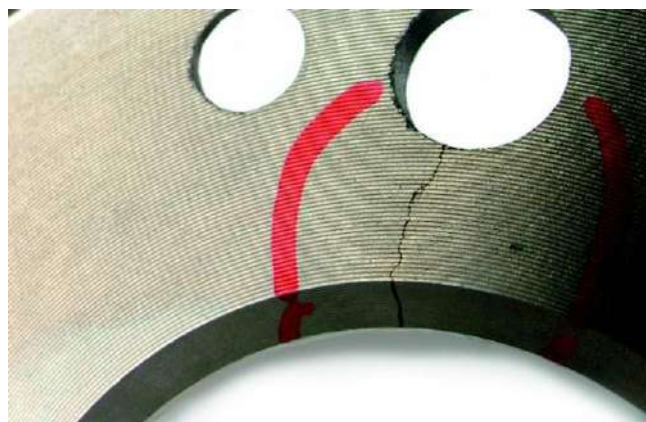
Рис. 2.11 – Термічні тріщини (радіальні) гальмівного диска [14]
