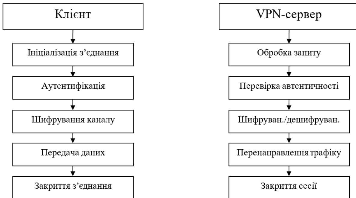
Рисунок 3.2 – Схема роботи пристрою на рівнях клієнт і сервер
