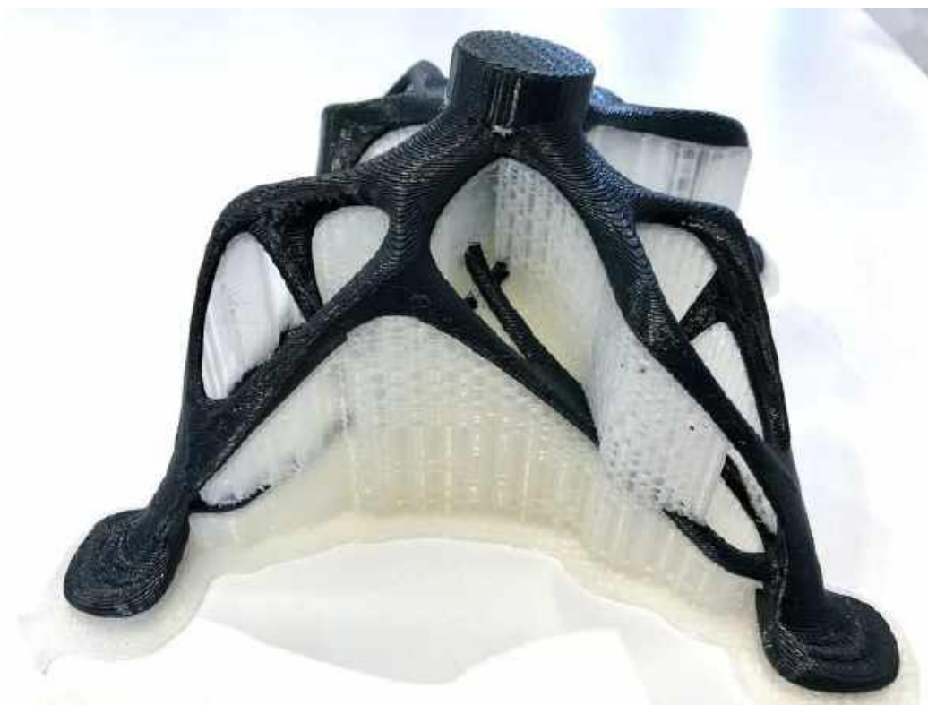
Рисунок 13 — Приклад надрукованої деталі із підтримками з іншого філаменту.
