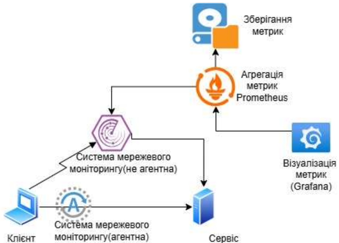
Рисунок 2.1 - Багаторівнева архітектура системи моніторингу гібридного типу
