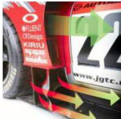
Рисунок 1.12 – Схема потоку повітря через бічні повітроводи.
