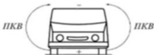
Рисунок 1.5 – Схема утворення поперечних кільцевих вихорів (ПКВ).
