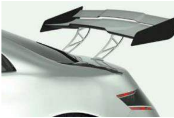
Рисунок 1.8 – Перевернуте крило автомобіля.
