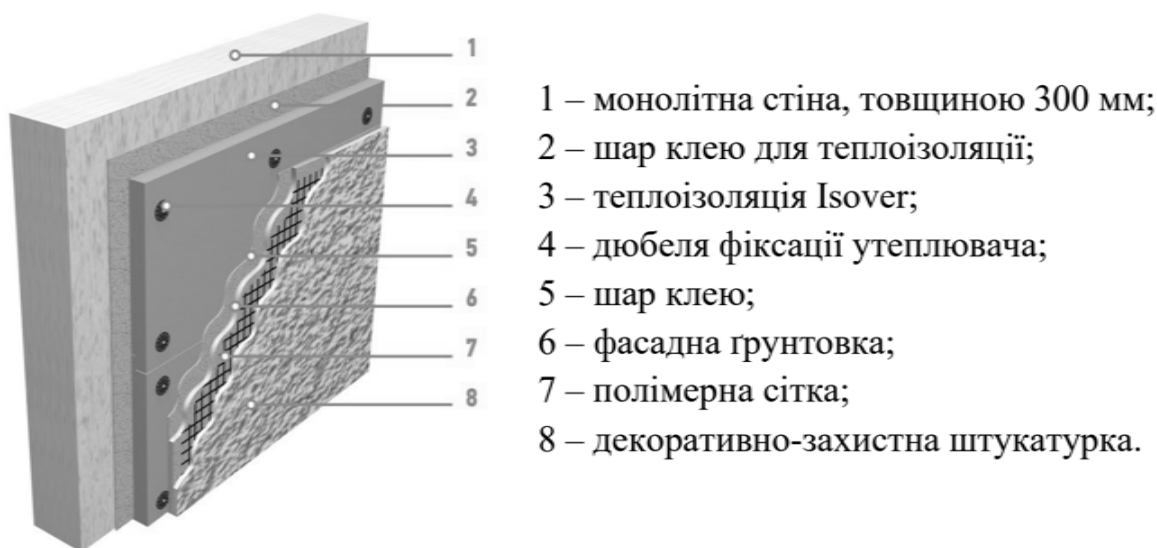
Рис.3.3 Конструкції зовнішніх несучих стін.
