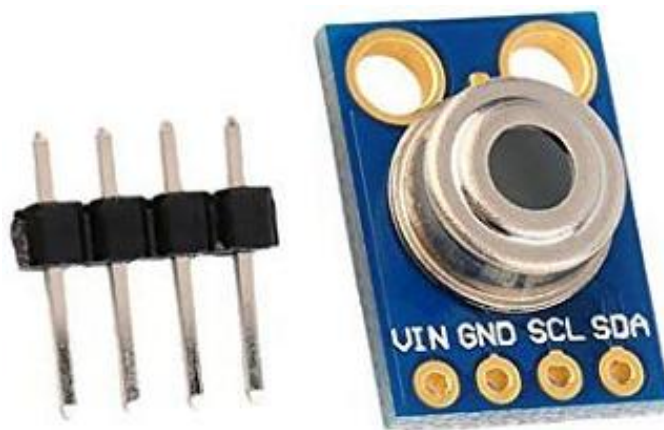
Рисунок 3.4 – MLX90614 - модуль безконтактного термометра
