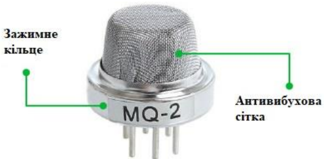
Рисунок 2.2 – Зовнішні компоненти газового датчика MQ-2[33]
