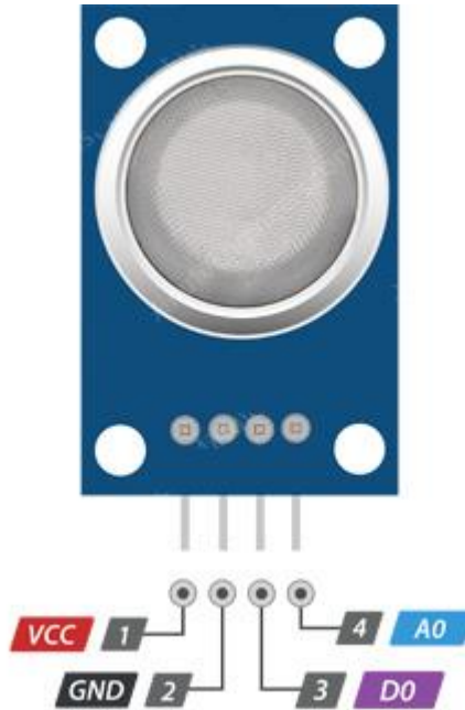
Рисунок 2.9 – Розпинівка модуля датчика газу [35]
