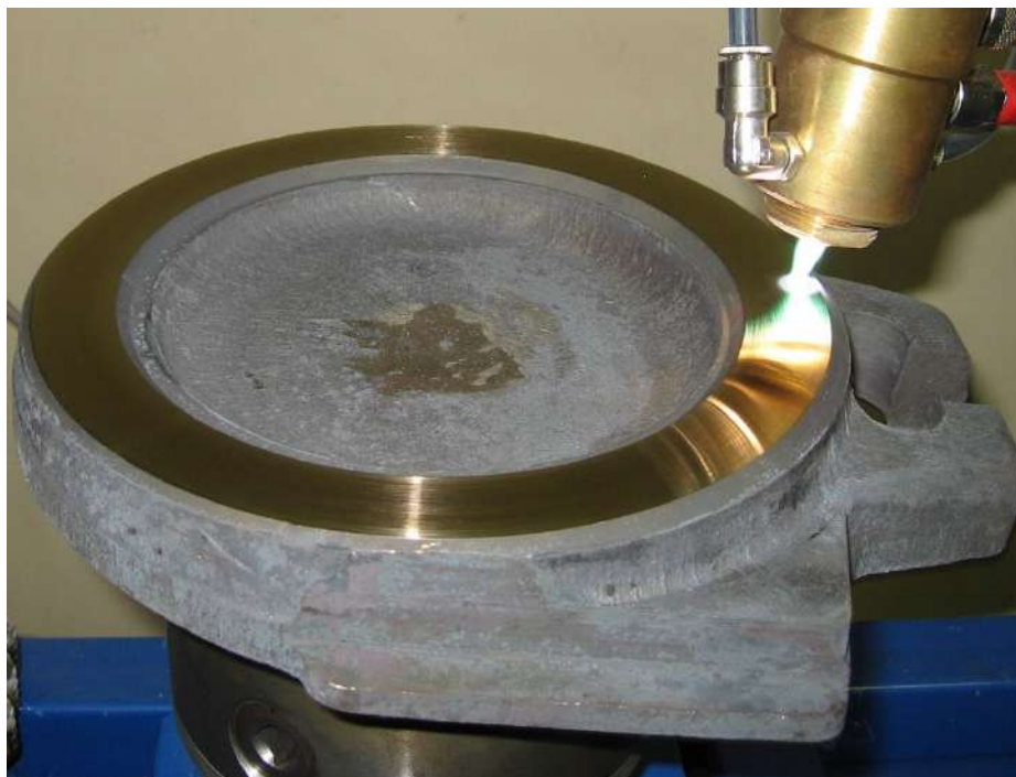
Рис. 2.1. Плазмова обробка деталей із сталі без оплавлення поверхні
