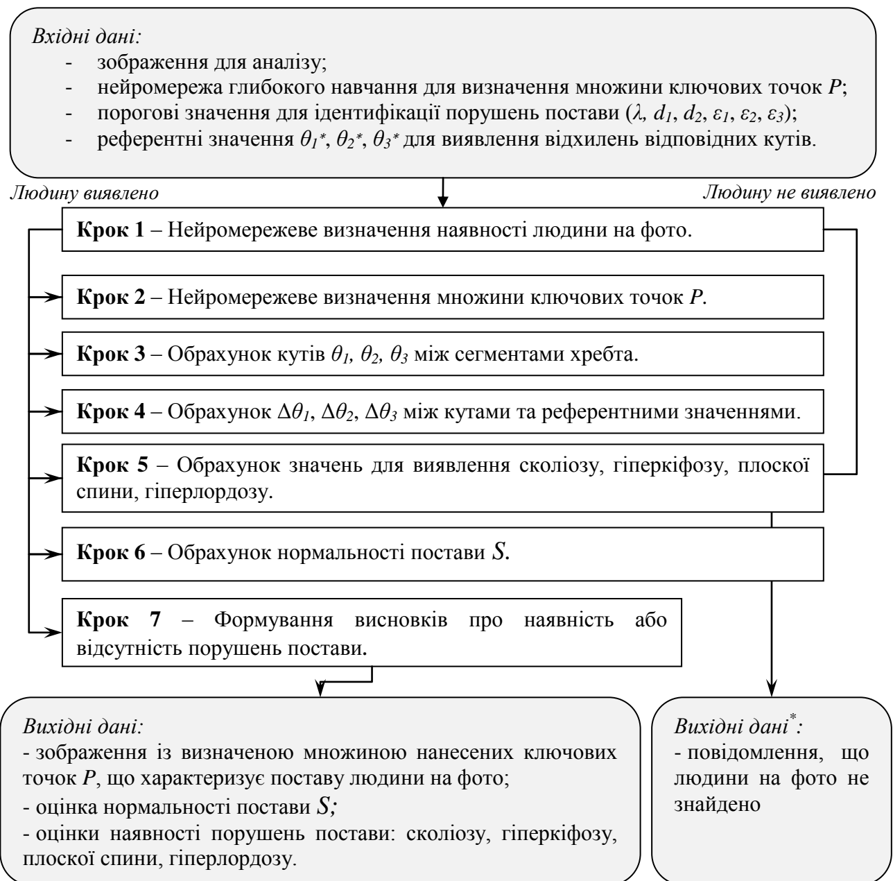
Рисунок 2.2 – Схема та кроки методу автоматизованого виявлення порушень постави людини за зображенням
