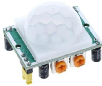
Рисунок 3.9 – Зображення датчику присутності HC-SR501
