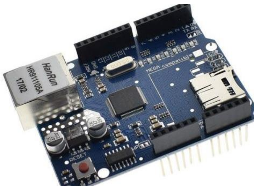
Рисунок 2.4 – Зображення плати Ethernet Shield
