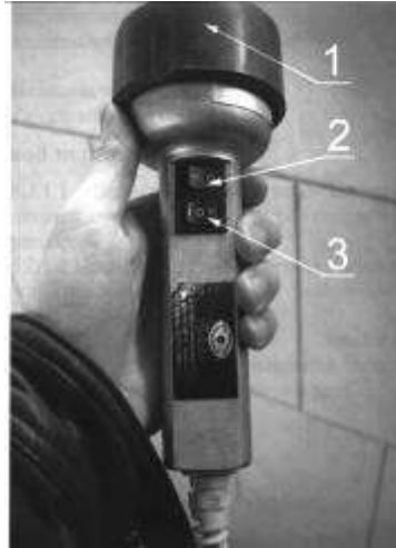
Рисунок 1.9 - Пульт керування рухливими майданчиками 1- вбудований ліхтар; 2 - вимикач ліхтаря; 3 - вимикач рухливих майданчиків.
