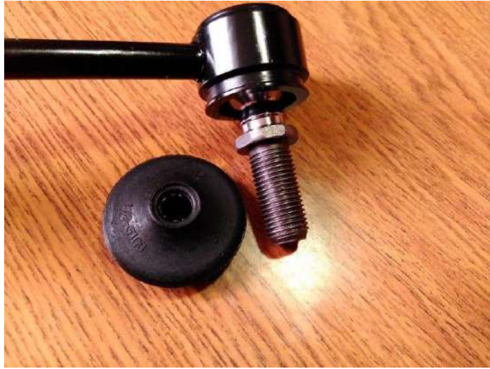
Рисунок 2.21 – Збирання стійка стабілізатора
