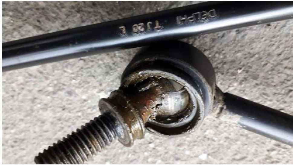
Рисунок 2.20 – Зруйнований шарнір стабілізатора
