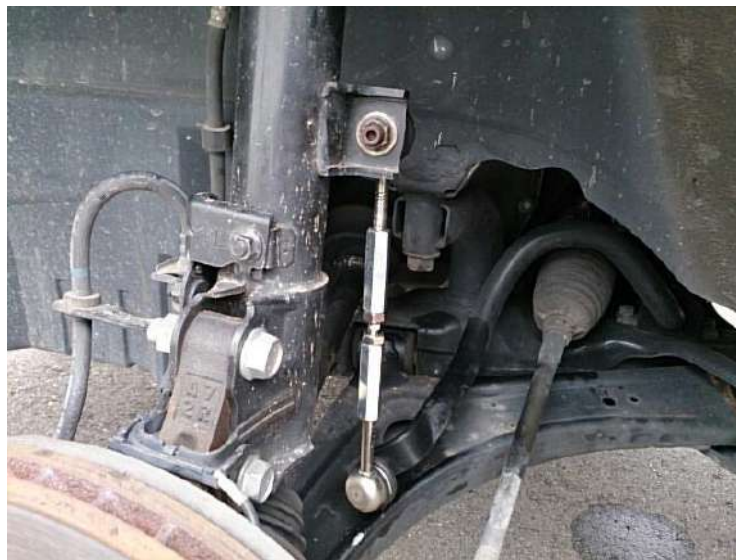
Рисунок 2.30 – Альтернативний варіант з нарізування різьблення
