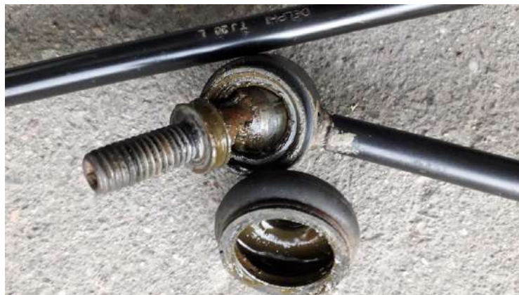
Рисунок 2.22 – Знятий пильовик стійки стабілізатора
