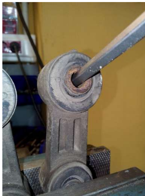
Рисунок 2.19 – Перевірка роботи стабілізатора
