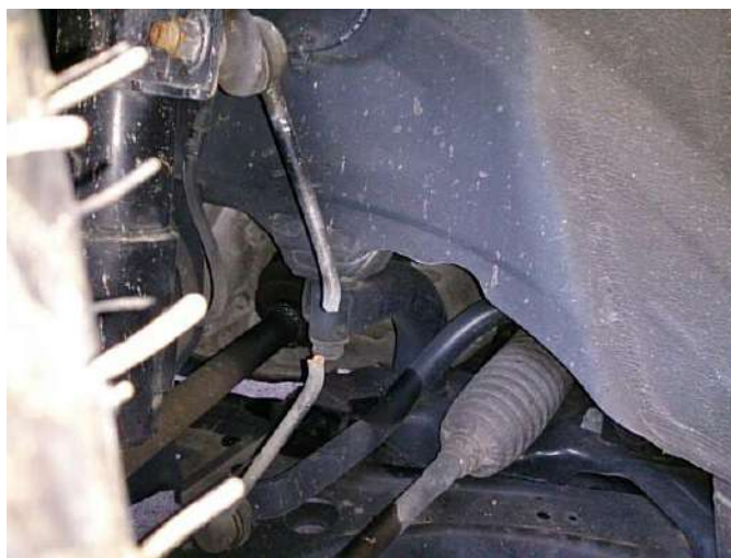
Рисунок 2.16 – Зруйнована стійка стабілізатора
