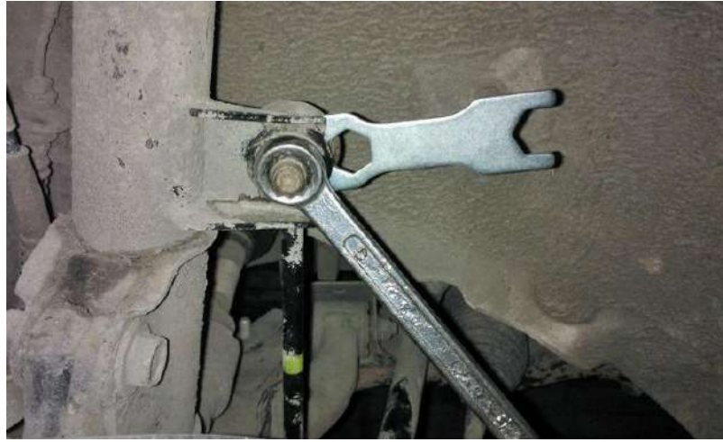
Рисунок 2.18 – Демонтаж стійки стабілізатора
