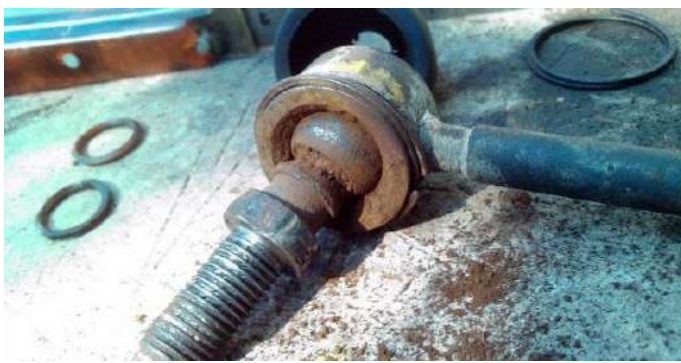
Рисунок 2.25 – Знятий пильовик стійки стабілізатора
