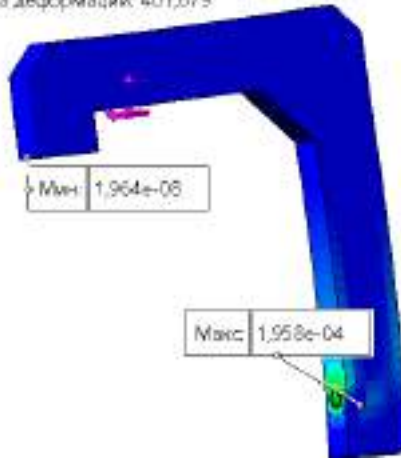
Рисунок 4.12 – Результаты расчета (а) и контурный график суммарных деформаций ESTRN модели захвата (б)
