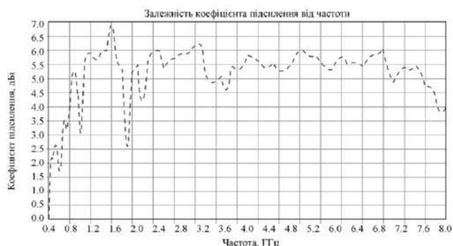
Рис. 13 – Підсилення вдосконаленої конструкції друкованої LPDA антени
