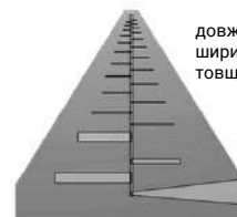
Рис. 12 – Модель запропонованої антени типу друкованої LPDA антени
