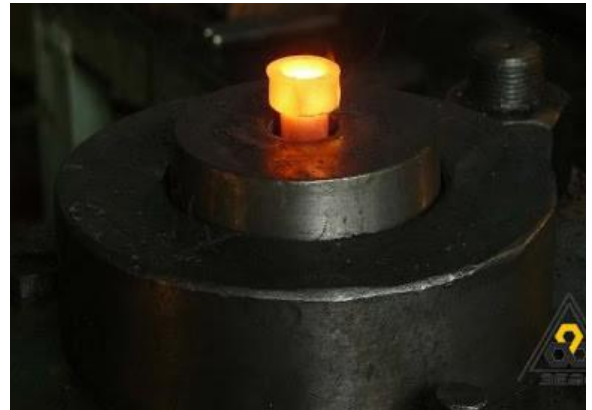
Формування головки болта на пресі із заготовки розігрітої індуктором до 1000°С
