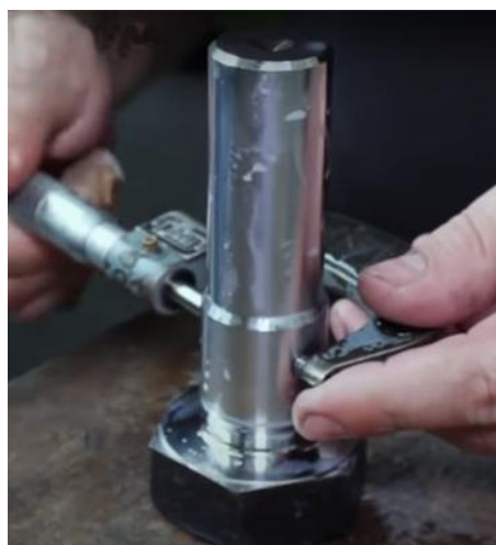
Рисунок 3.13 - Контроль лінійних розмірів болтів
