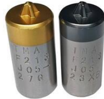
Рисунок 2.8 - Пуансони і матриці для першого і другого удару при виготовленні саморізів.
