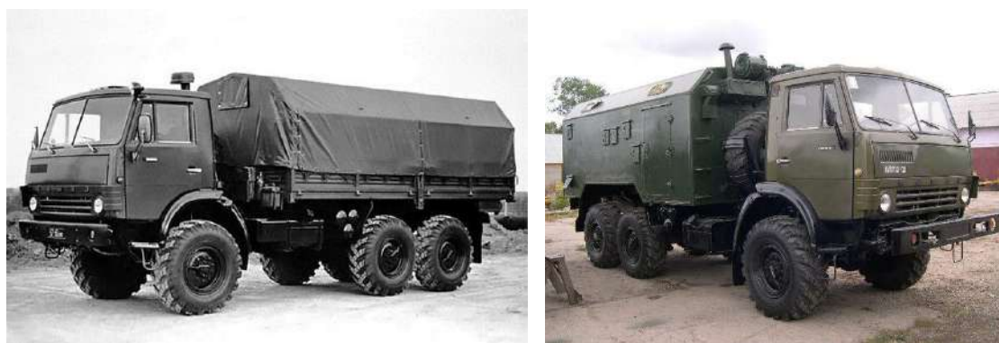
Рисунок 1.1 – Загальний вигляд повнопривідного тривісного вантажного автомобіля підвищеної прохідності КамАЗ-4310 [1, 2]
