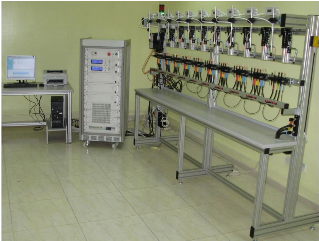
Рисунок 1.3- Обладнання для перевірки лічильників електроенергії ELMA з фіксованою системою обробки лічильників (стандартне, вертикальне розміщення лічильників)
