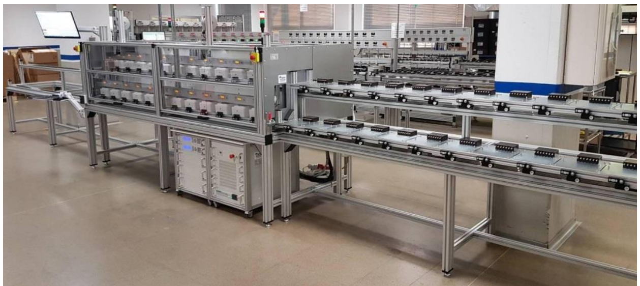
Рисунок 1.4 - Обладнання для перевірки лічильників електроенергії ELMA з горизонтальним розміщенням лічильників - повністю автоматичне (настроюване, горизонтальне розміщення лічильників)
