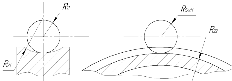
Рис. 2.2. – Схема контакта шарика и дорожки качения в РПК
