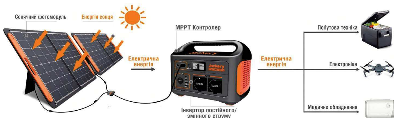
Рисунок 1.6 – Схема роботи портативної сонячної електростанції [13]
