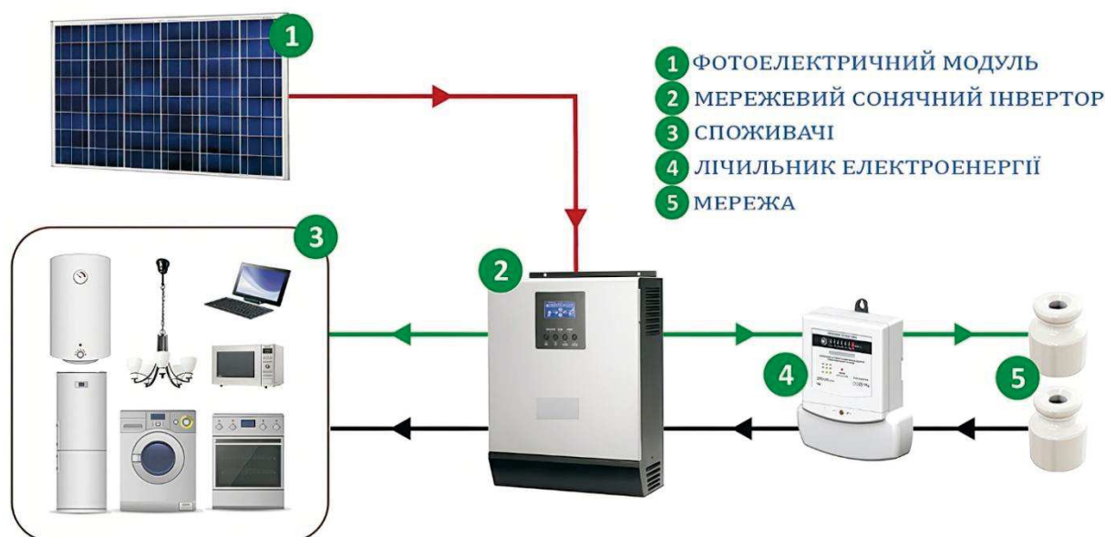
Рисунок 1.2 – Схема роботи мережевої сонячної електростанції [5]
