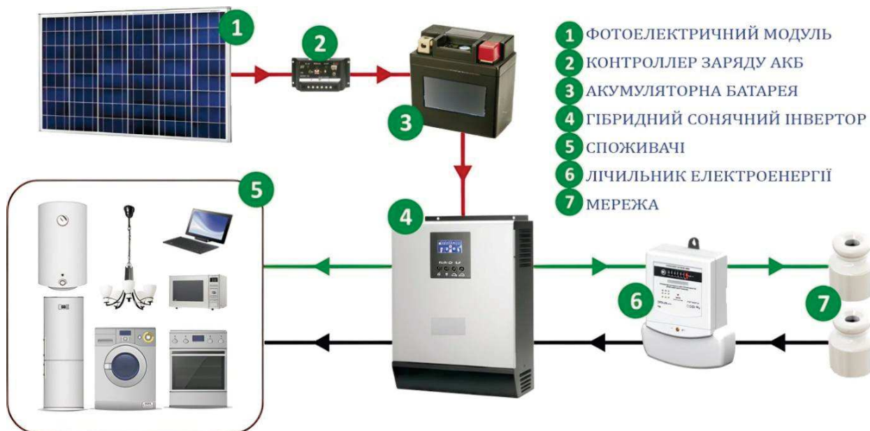
Рисунок 1.8 – Схема роботи гібридної сонячної електростанції [5]
