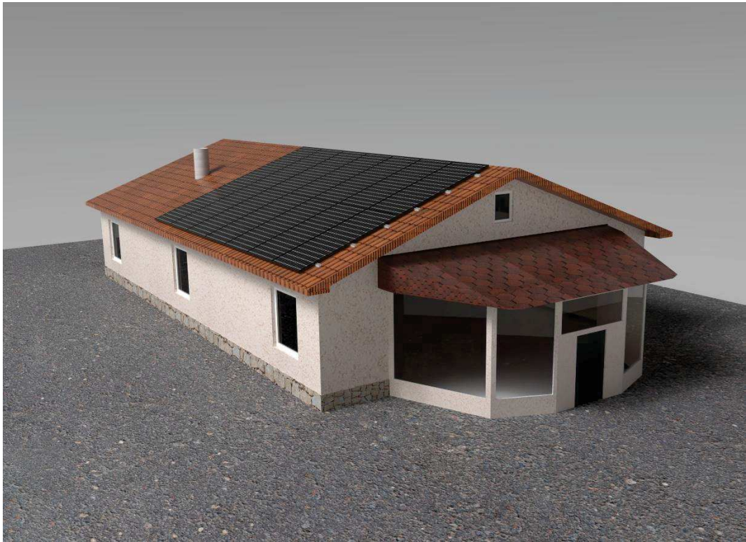
Рисунок 2.11 – Розміщення фотоелектричних модулів (загальний вигляд)
