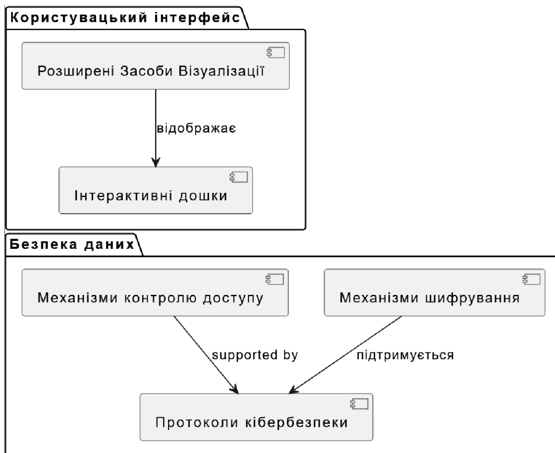
Рисунок 2.7 – Блок схема користувальницького інтерфейсу та аспекту безпеки даних системи
