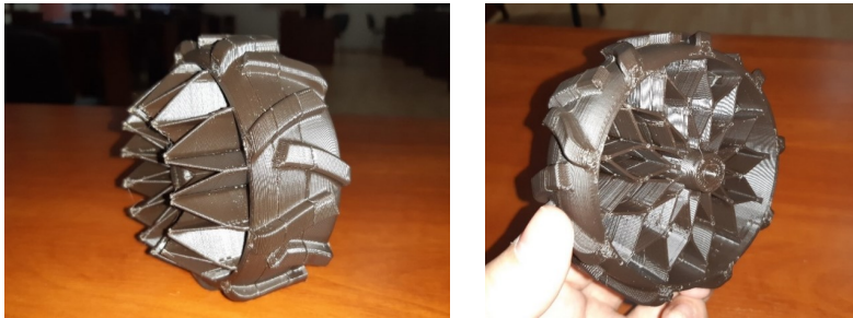
Рис. 3. Виготовлена модель колеса робомашинки на 3D-принтері
