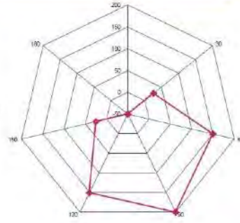
Епіюра розподілу тангенціальних напружень \sigma_t на контурі еліптичного отвору ( a/b = 0,5 ) при одноосному розтягу 10
