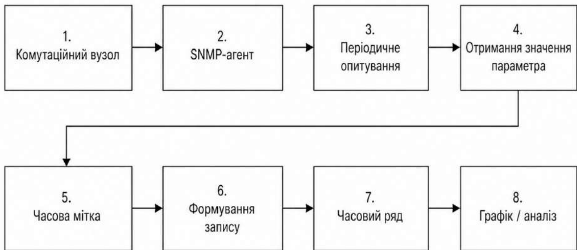
Рисунок 2.2 – Схема формування часового ряду мережевого параметра в системі моніторингу
