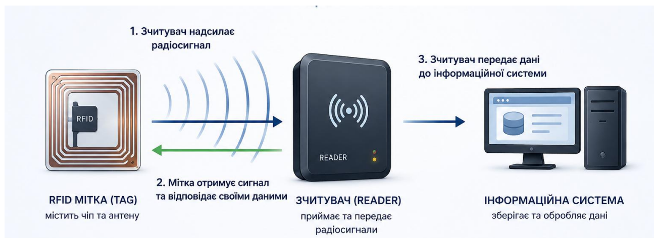
Рисунок 1.1 – Функціонування інформаційної системи із застосуванням RFID технології
