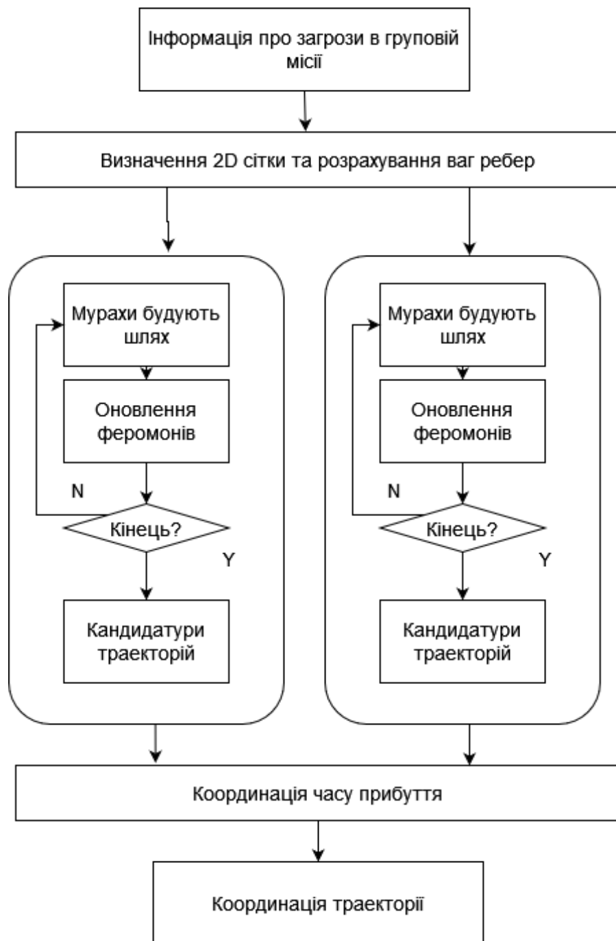
Рисунок 4.2 – Застосування АСО до проблеми координації кількох БПЛА
